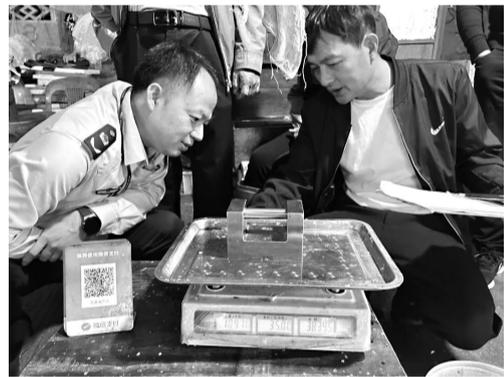
检查人员携带砝码现场校准检定
