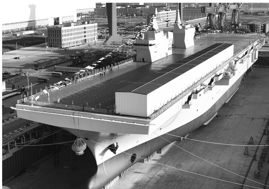
四川舰满载排水量4万余吨,设置双舰岛式上层建筑和全纵通飞行甲板(新华/图)
