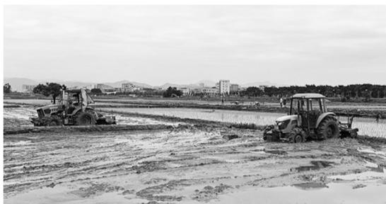
无人(辅助)驾驶轮式拖拉机正进行水稻机耕作业
