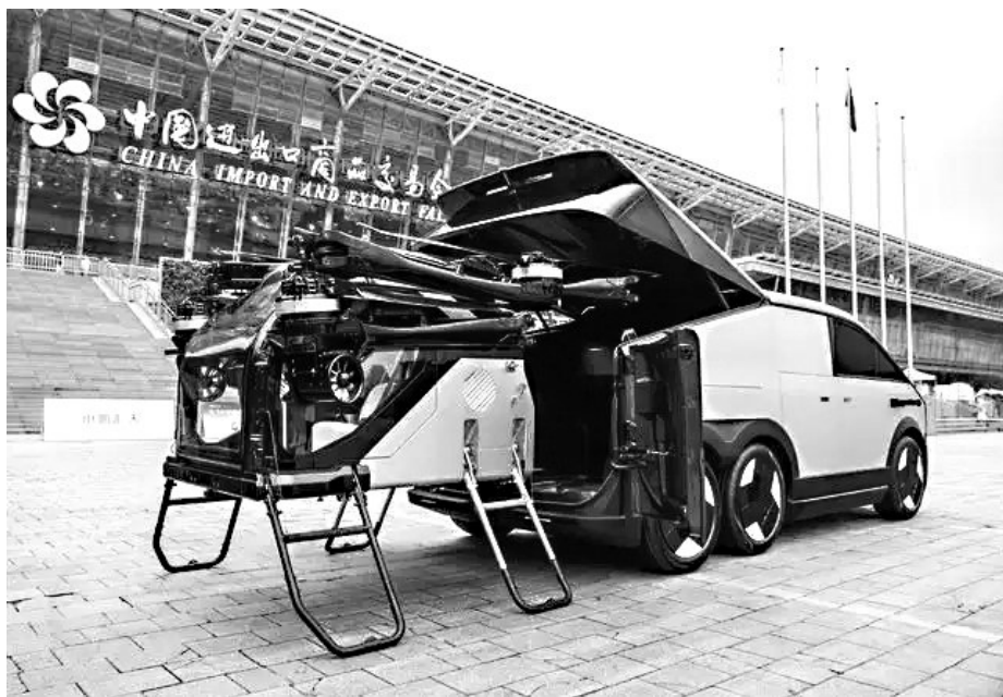
『陆地航母』分为陆行体和飞行体两部分,飞行体能装进陆行体后备箱
