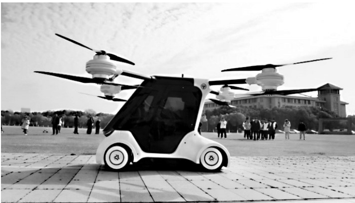
转向全轮驱动、四轴八桨构型飞行汽车 『东大·鲲鹏1号』是国内首辆全轮
