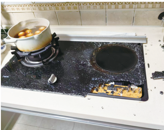
刘先生家的燃气灶玻璃面板炸裂(受访者供图)
