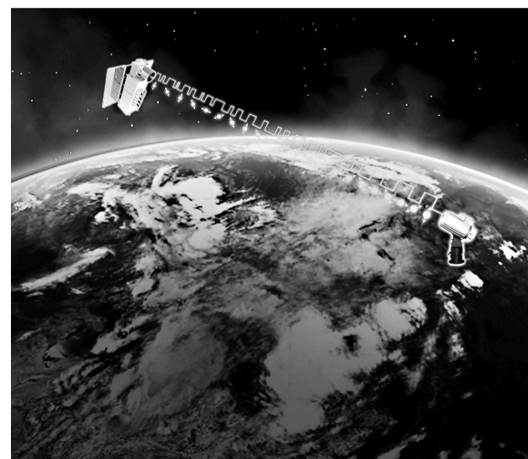
这是量子微纳卫星“济南一号”星地量子密钥分发实验示意图
