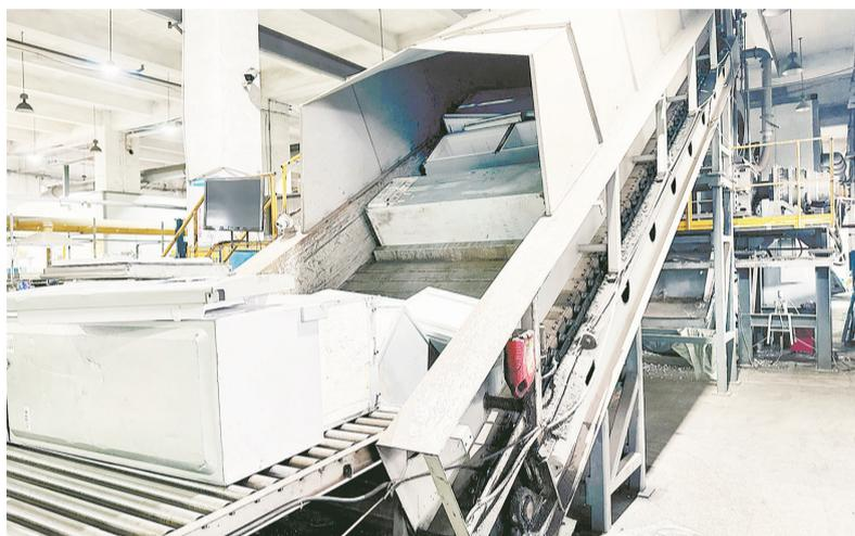
在福建宏源的车间内,废旧冰箱被送上生产线自动破碎 (福建日报/图)
