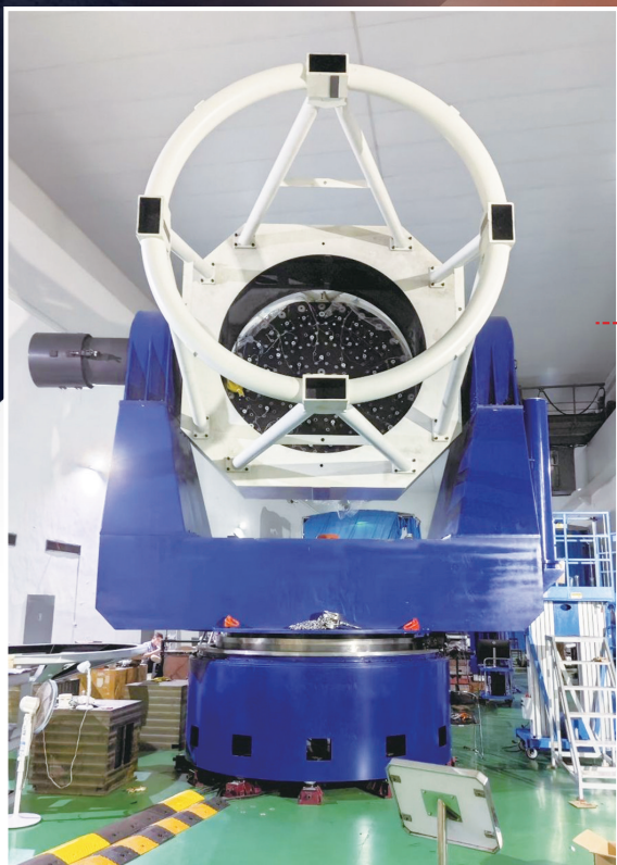
建造中的“2.5米大视场高分辨率太阳望远镜”本体(南京大学供图)
