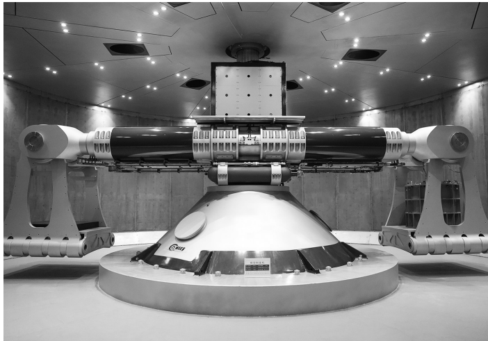
超重力离心模拟与实验装置启动的首台离心机主机“CHIEF1300”
